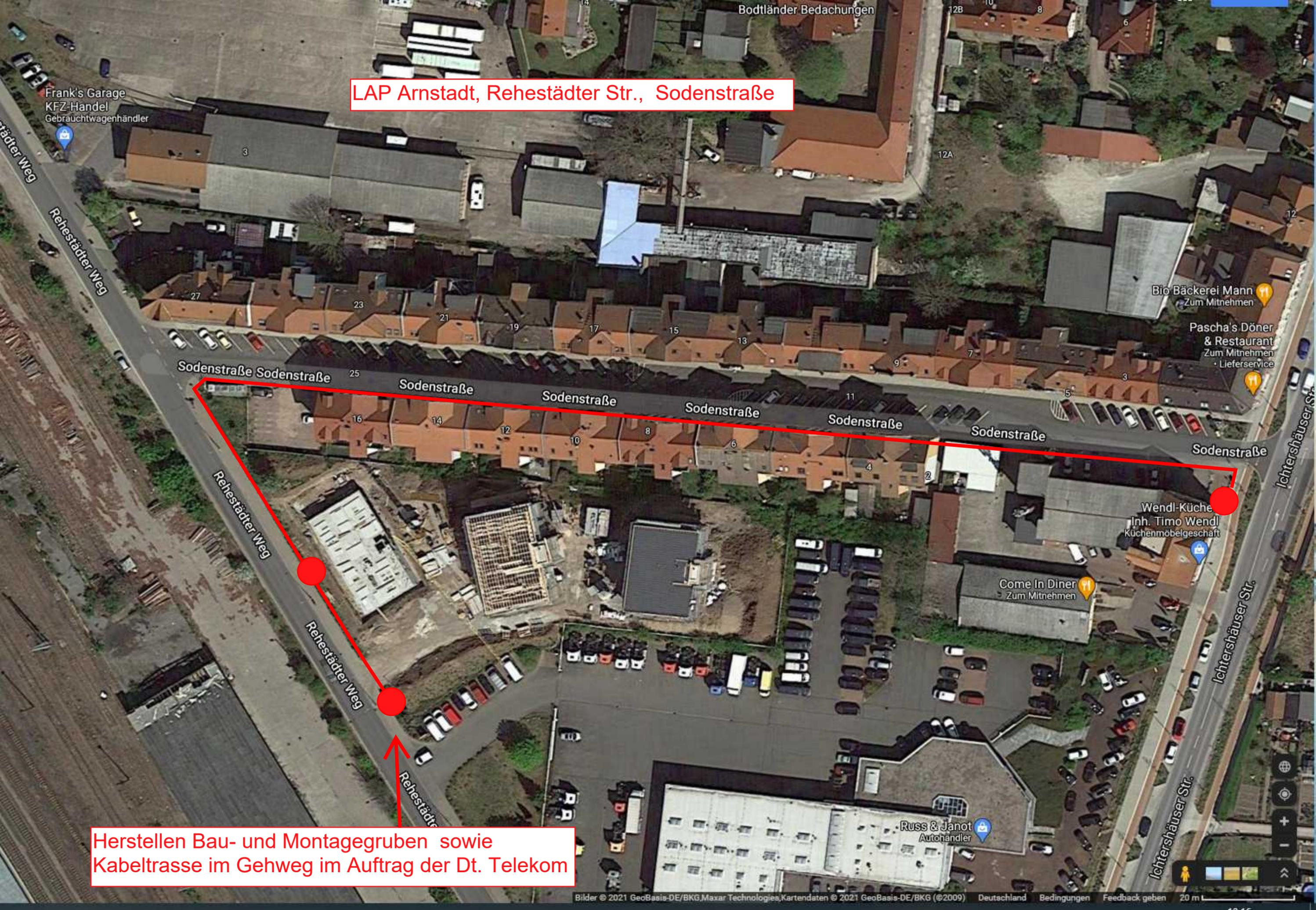
Herstellen Bau- und Montagegruben sowie Kabeltrasse im Gehweg im Auftrag der Dt. Telekom
